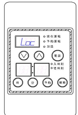
チャイルドロック設定時、又は、チャイルドロック状態時にキーを入力した場合はL o cと表示されます。
